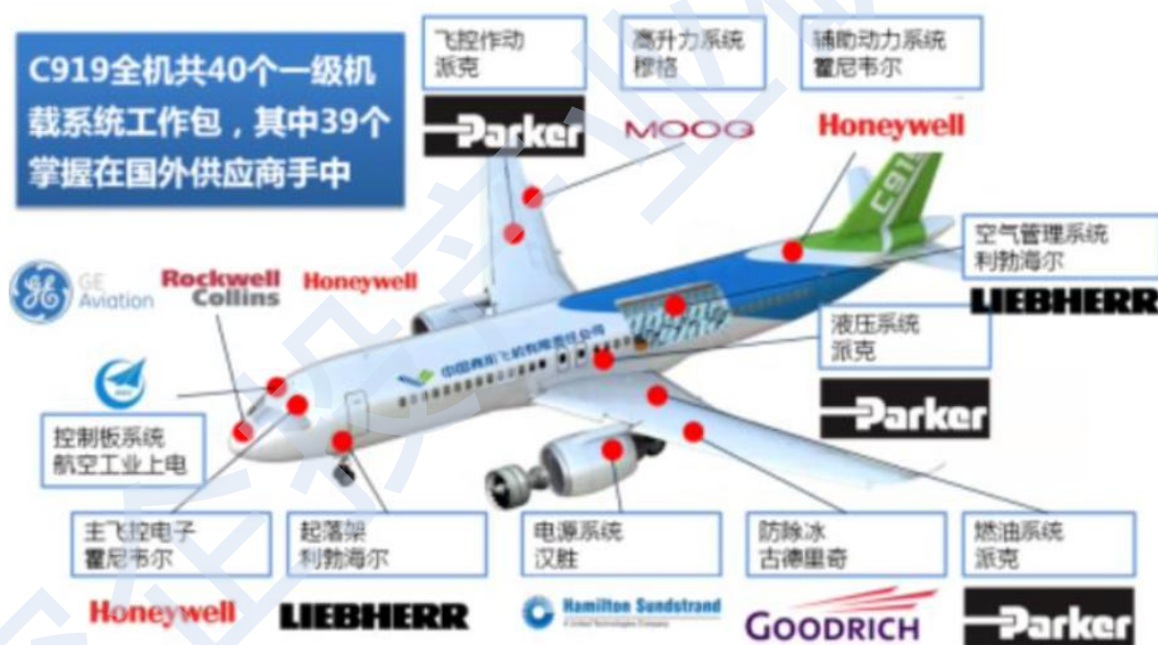
图 12 C919 部分核心机载系统工作包分布情况
