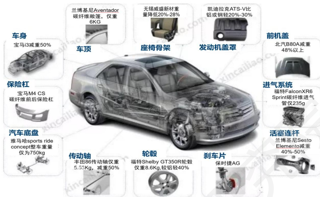
图6 碳纤维复合材料在汽车的具体应用和减重效果
