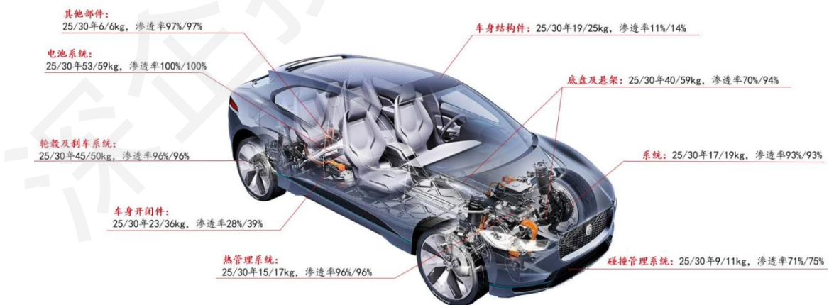
图 3 纯电车型各结构部件单车用铝量及渗透率预测
