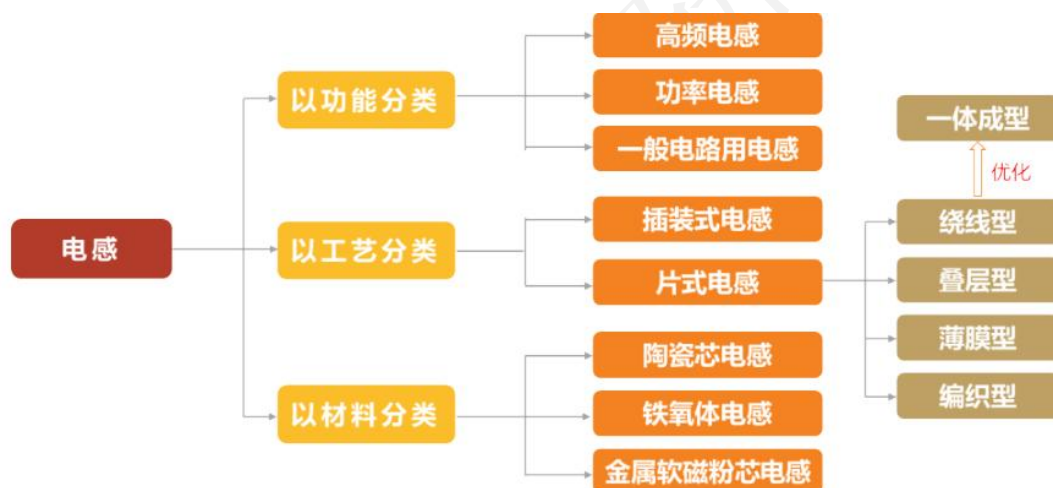
图1 电感器主要分类示意图
