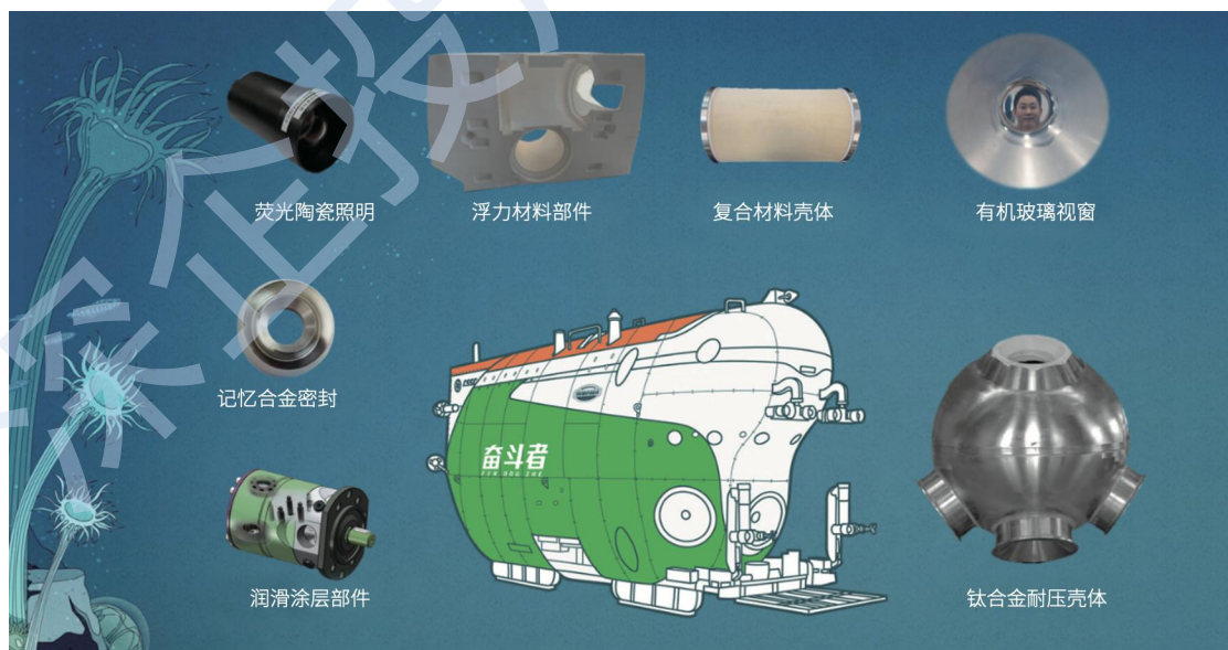
图 16 深海观测探测平台应用的主要材料及部件
