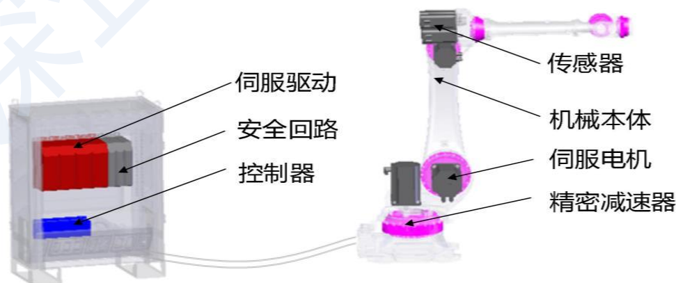
图1 工业机器人结构
